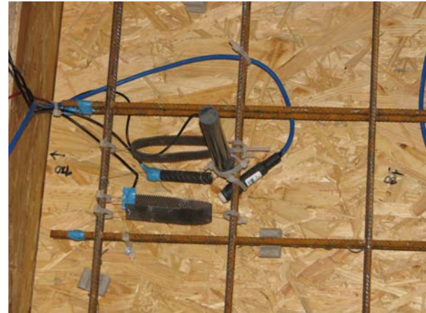
Bild 3: Makroelement (Betonstahl = Anode, Titanband = Kathode)
