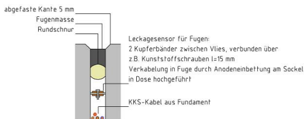
Bild 5: Feuchtesensoren in Bodenfugen über kritischen Fundamentbereichen
