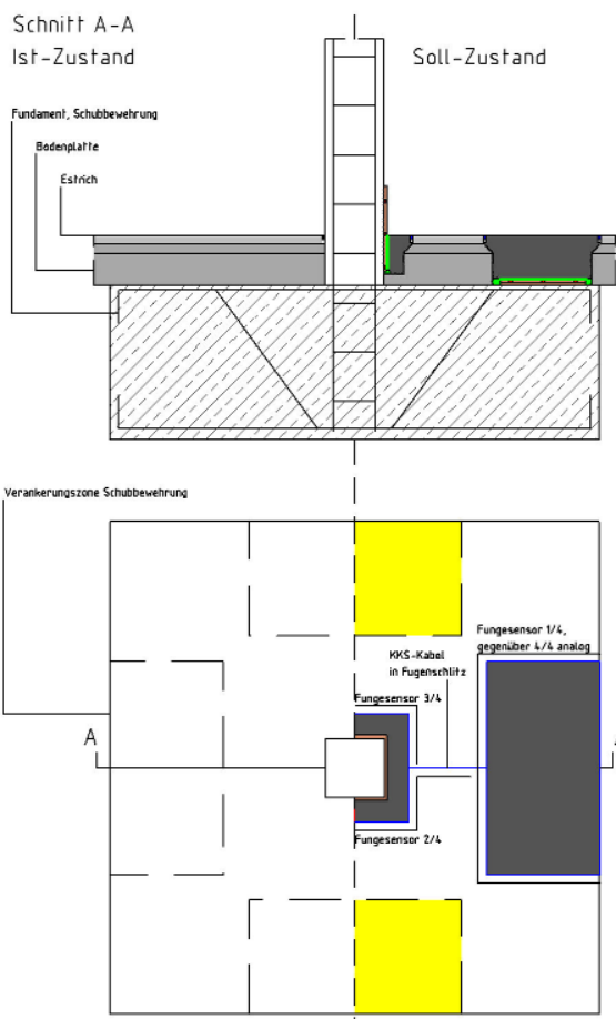
Bild 2: Einzelfundamente von Stützen mit KKS
